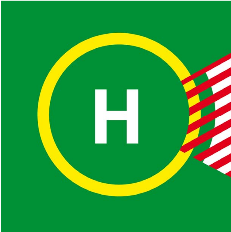
Bild 7. Markering av sektor för förbjuden landning på helikopterflygplats på en plattform.
